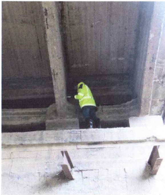
სურ. დ-17. ხიდის კონსტრუქციების ბეტონის კლასის შემოწმება „SILVER SHMIDT“-ის გამოყენებით
